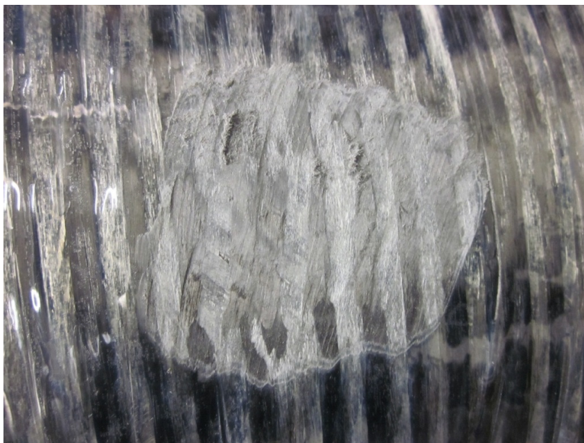
Segni di abrasione sulla superficie del serbatoio
