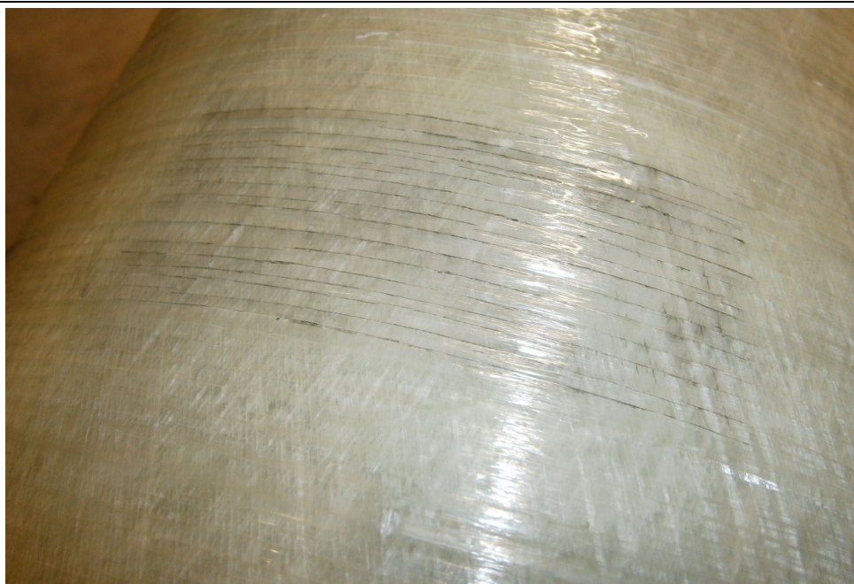
Microincrinature parallele nello strato epossidico
