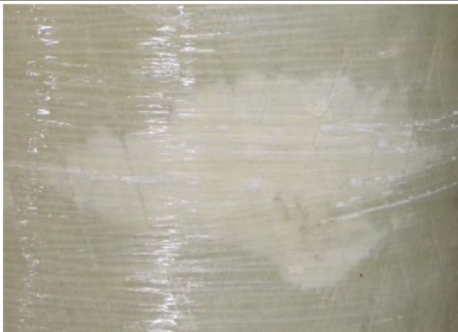
Decolorazione dei filamenti
