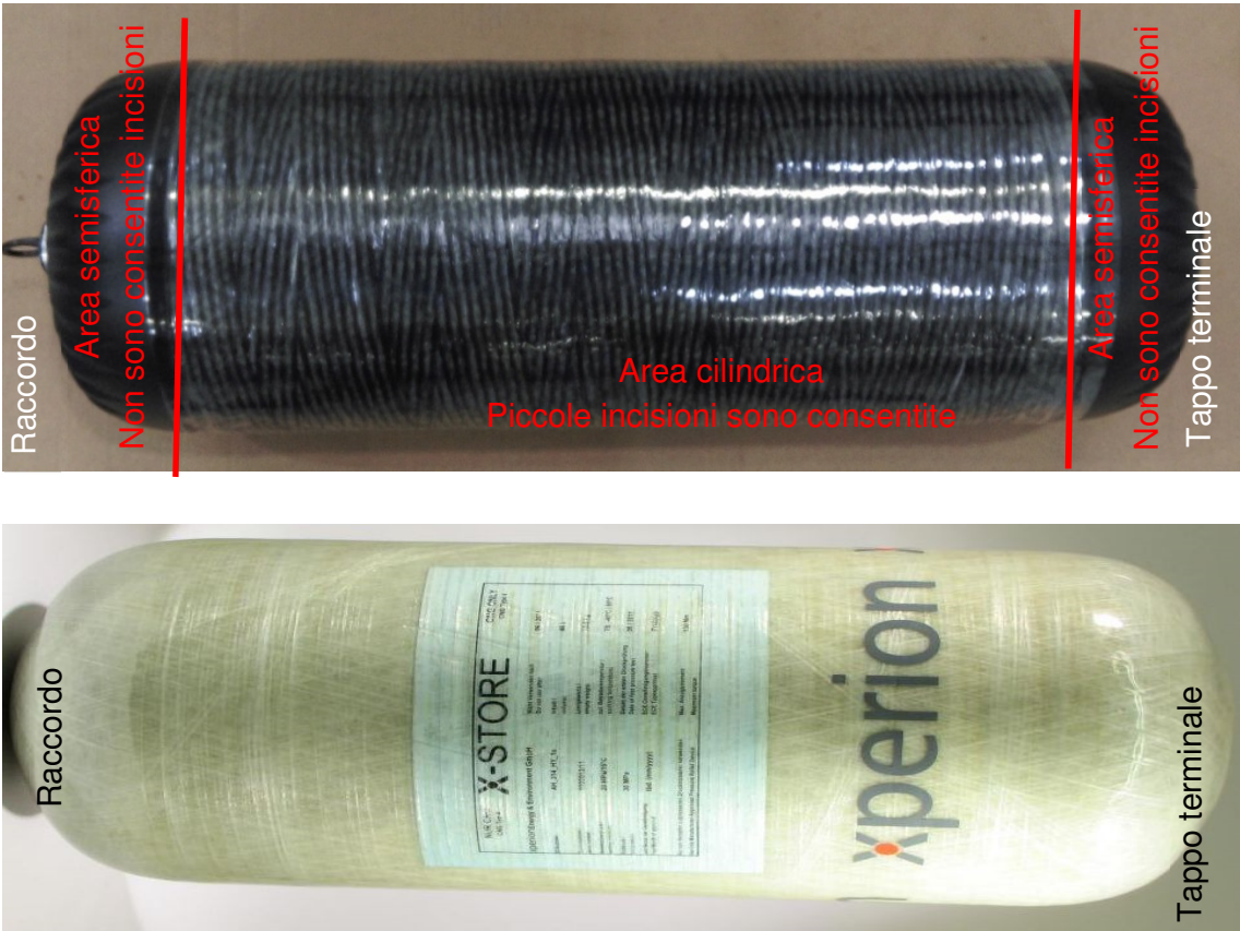
Figura 15: aree di una bombola di tipo 4
