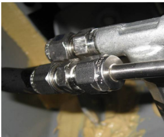
Figura 12: collegamento a vite a tenuta, assenza di bolle dopo 3 min
