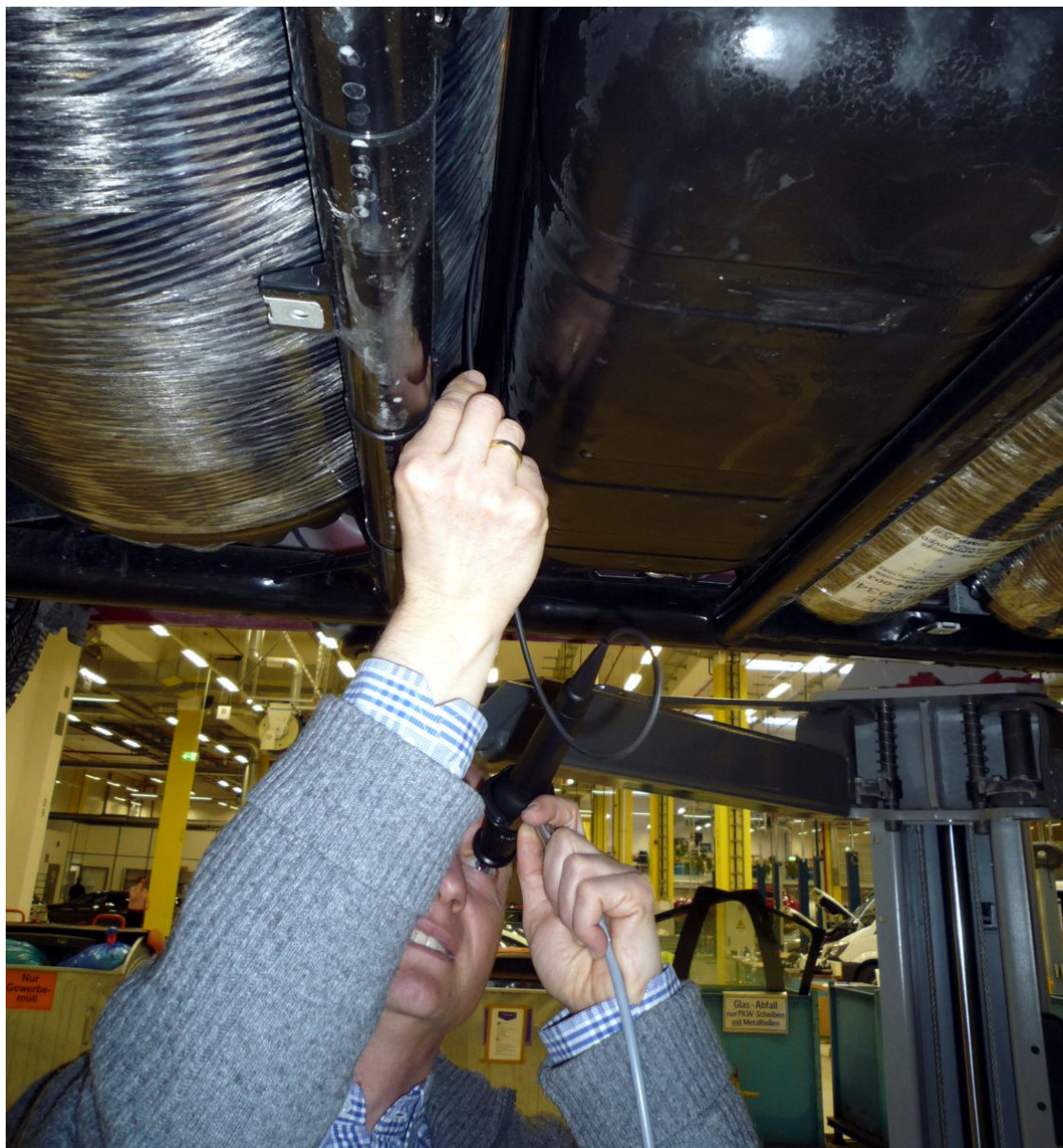
Figura 9: mediante un endoscopio, il meccanico ispeziona le zone non visibili
